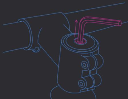
Снимите установленную на заводе крышку с вашего велосипеда
