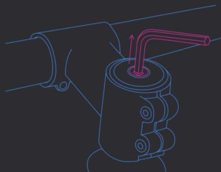
Entferne die werkseitig montierte Kappe von Deinem Fahrrad
